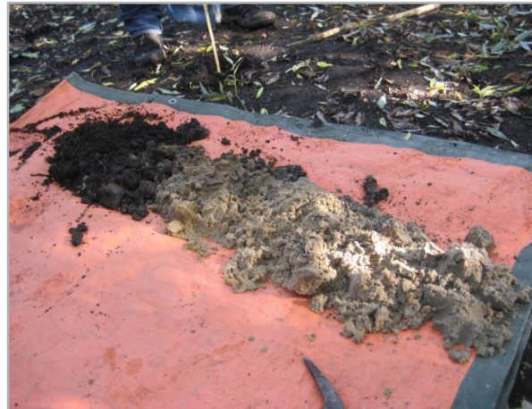
Abbildung 19: Bohrprobe auf Höhe des Einlaufbauwerks im Regenrückhaltebecken (Eigene Fotografie vom 11.09.2019)
