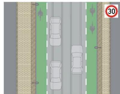
Umbau mit einer Fahrbahnbreite von 9,50 m und beidseitigen Fußwegen mit Breiten möglichst > 2,50 m und beidseitigen Radfahrstreifen oder Schutzstreifen für den Radverkehr auf der Fahrbahn
