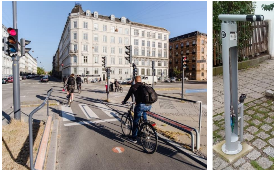
Abbildung 40: Trittbrett und Haltegriff an einem Knotenpunkt in Kopenhagen und eine öffentliche Luftpumpe mit Werkzeug in Sonthofen
