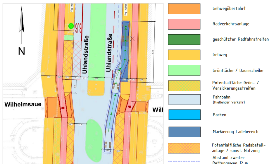
Abbildung 29: Schleppkurvenprüfung für die Ladezone in der Uhlandstraße
