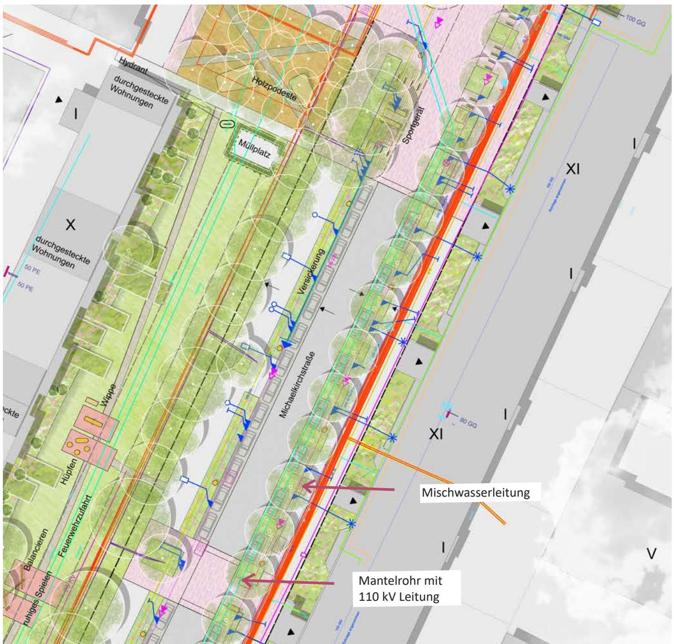
Abb. 112 Ausschnitt Überlagerung Vorzugsvariante und Bestandsleitungen, o.M. im Original M 1:500
