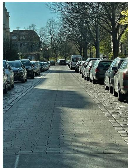
Abb. 3: Beispiel für einen Streifen mit geschnittenem Großpflaster für Radfahrende
