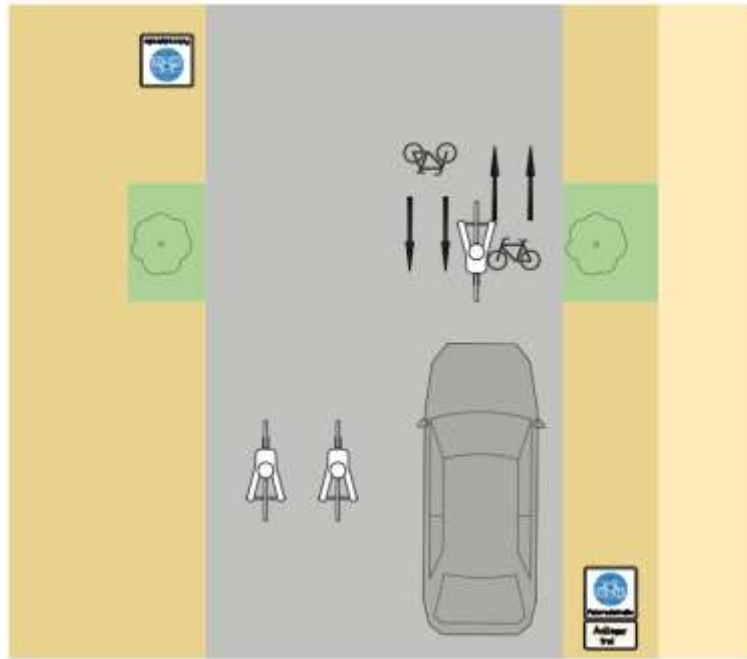
Abb. 32: Straßenquerschnitt Hentigstraße - Variante 5, Situation mit Halteverbot, z.B. 7-19h oder 7-11h & 15-19h
