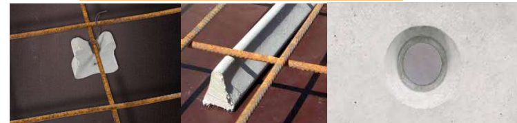
2017: Asbesth. Abstandhalter + Mauerstärken im Betonbau
