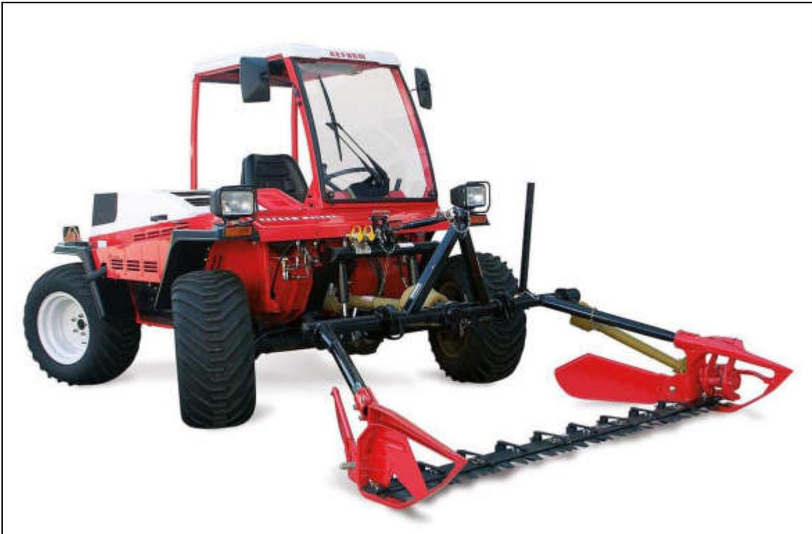
**Abb. 9:** Reform „Metrac“ mit Doppelmessermähwerk
