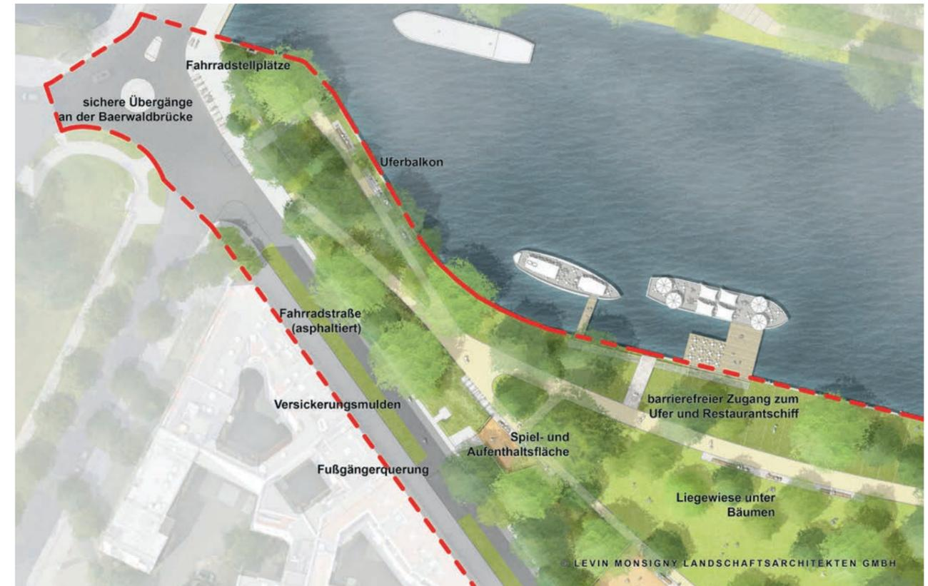
Lageplanausschnitt Carl-Herz-Ufer: asphaltierte Fahrradstraße mit Versickerungsmulden und sicheren Querungsstellen an der Baerwaldbrücke
