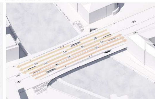
Fertigstellung Projektphase 0 Inbetriebnahme Verkehr Überbau 2
