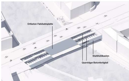
Bauphase 4 1. Betonage der Ortbeton Fahrbahnplatte auf der Stahlkonstruktion 2. Einbau und Anschluss der vorgefertigten Querträger aus Beton (zwischen Trägern) und Stahlhohlkasten (außen)
