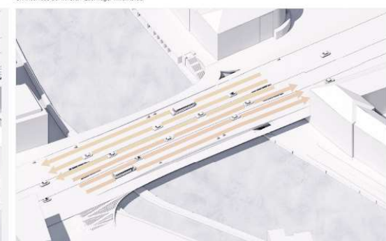
Fertigstellung Projektphase 0 Inbetriebnahme Verkehr Überbau 2
