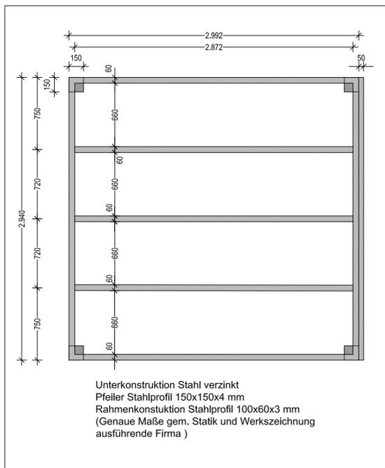
Tragende Unterkonstruktion M 1: 25 - mm
