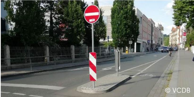
Reduzierung der für Kfz nutzbaren Breite im Einfahrbereich durch bauliche Maßnahmen bei ungehinderter Befahrbarkeit für Fahrradverkehr
